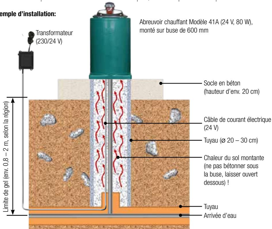
Abreuvoir chauffant Modèle 41A (24 V, 80 W), monté sur buse de 600 mm
