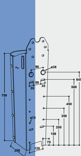
Vue de derrière : Support acier avec Mod. 25R-VA $\frac{3}{4}$ " et kit de montage sur circuit en boucle $\frac{3}{4}$ "
